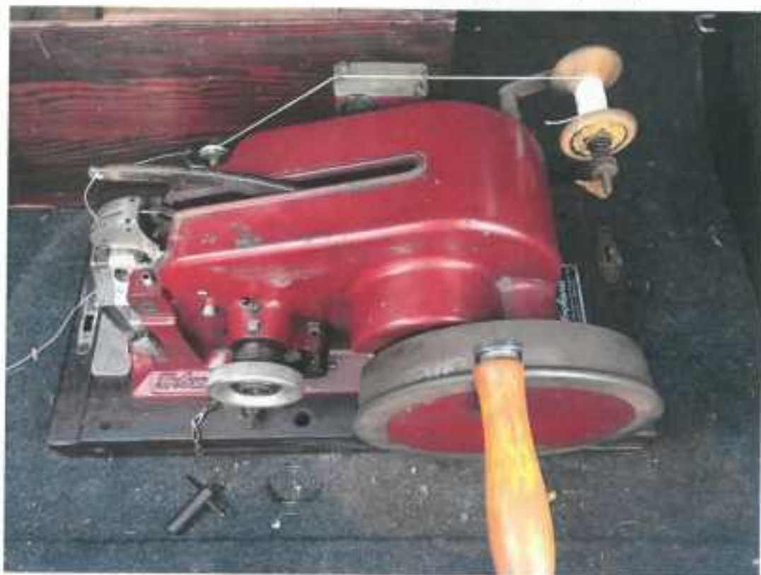
Šicí stroj FROBANA na kličku speciálně na rámečky podešve (1936)
